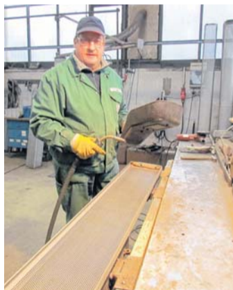
Roland Juckel schweißt die Filterkörbe zusammen, die im Inneren der Filteranlagen ihren Dienst verrichten werden.
