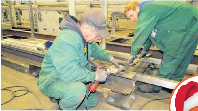
Schlosser Uwe Littwin (links) und Florian Goldenstern schweißen die Rahmen zusammen, in denen später die Filterkörbe installiert werden.
