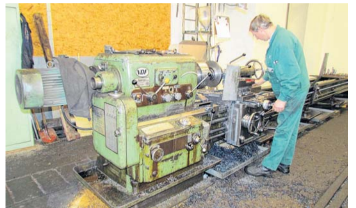
Bernd Rechendorf ist Dreher und arbeitet an der Drehbank gerade an einer Antriebsachse für eine Schneckenpresse - noch ein Teil, das in Kläranlagen eingebaut wird.
