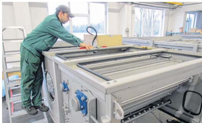
Michael Preisinger, Schlosser und in dem Walower Unternehmen für die Lehrlingsausbildung zuständig, montiert einen so genannten Center Flow Rechen, ein Teil, das in große Kläranlagen eingebaut wird.
